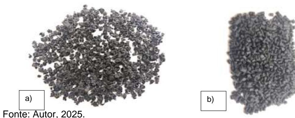
Figura 6 – Material processado na extrusora, onde: a) Masterbatches de carvão, com 5% de concentração de carvão mineral e b) Primeira formulação com PEAD + 15% de PEBDL + 15% de Masterbatches + 5% de Plastificante.
