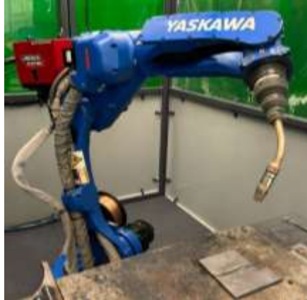
Figura 11: Máquina de solda automatizada e braço robótico
