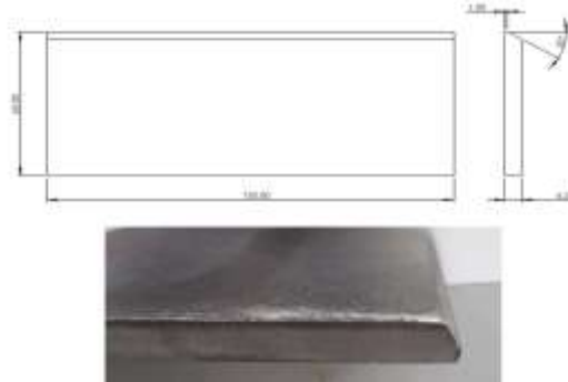
Figura 06: Preparação do corpo de prova: a) Fresa para confecção do chanfro; b) Chapa com chanfro.
