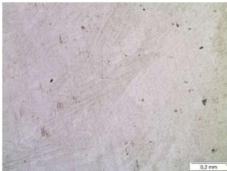
Figura 6: Microestrutura da região de solda com arame 308L. Ampliação de 100x.
