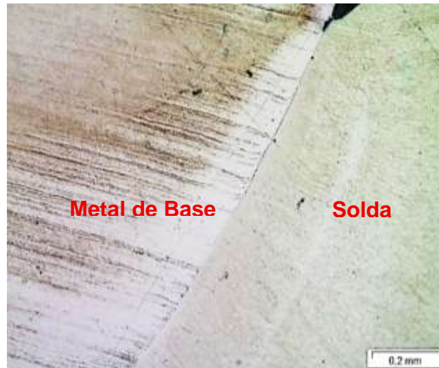
Figura 3: Metalografia Junta com eletrodo E-310. Transição entre solda e Metal de Base. Ampliação de 100x.
