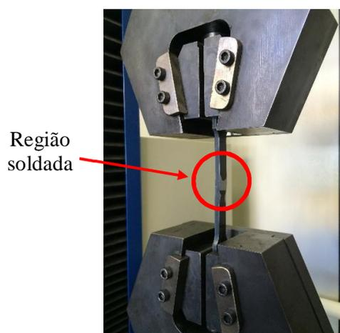
Figura 8: Ensaio de tração.
