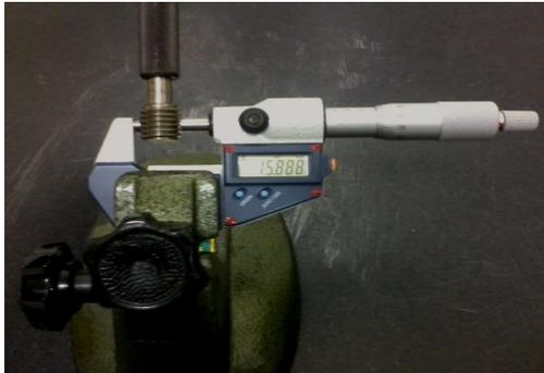
Figura 25: Medição do diâmetro externo.
