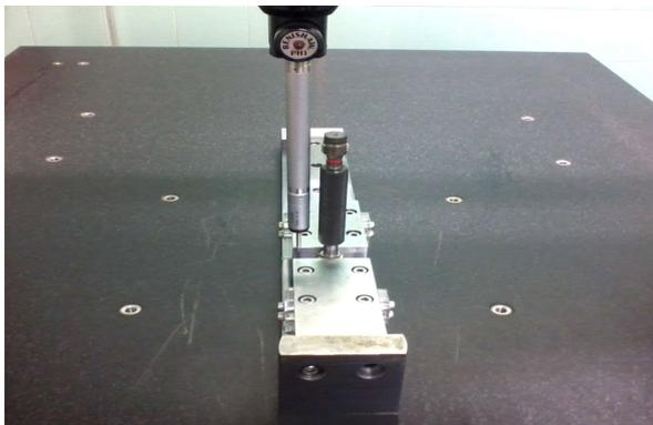
Figura 26: Medição do diâmetro externo com M.M.C
