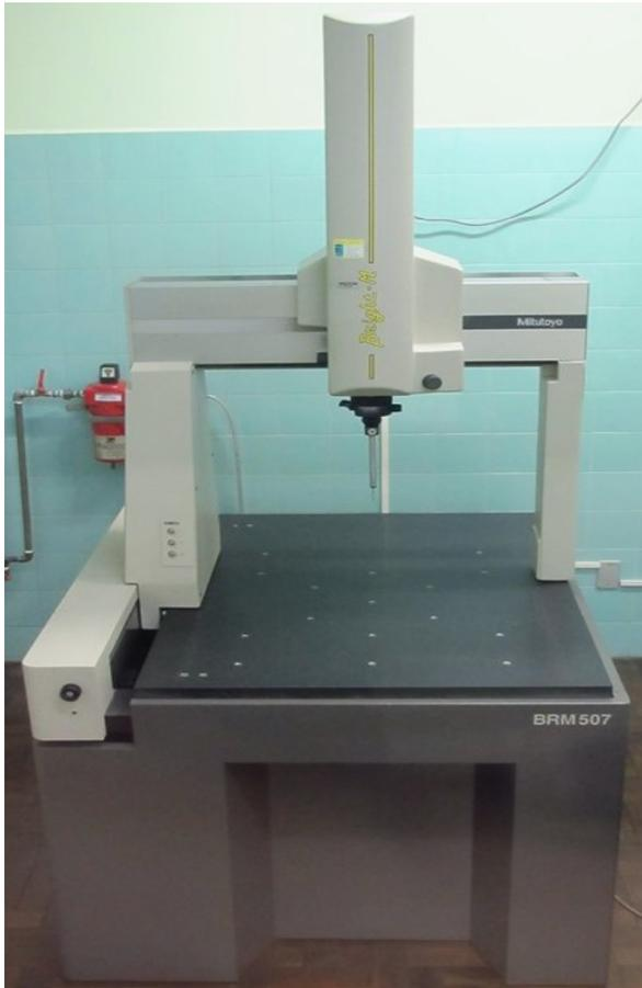
Figura 22: Máquina de medição por coordenadas Mitutoyo Bright-M 507.
