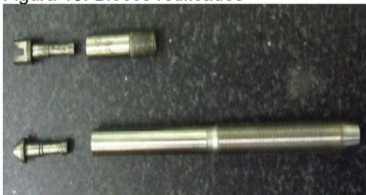
Figura 20: Fusos com as pontas intercambiáveis de contato
