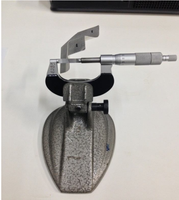
Figura 18: Medição em diferentes pontos no material Fonte: Os autores
