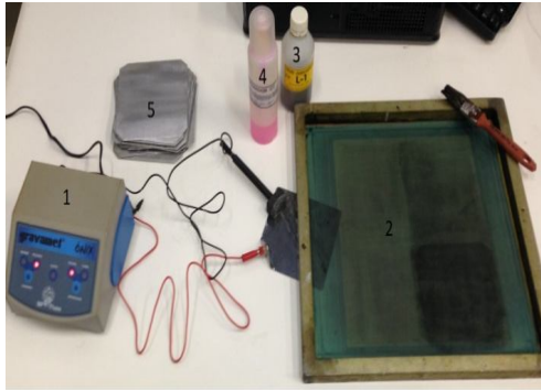
1-Máquina, 2- Matriz, 3- Líquido Reagente, 4- Neutralizador, 5- Blanks.
