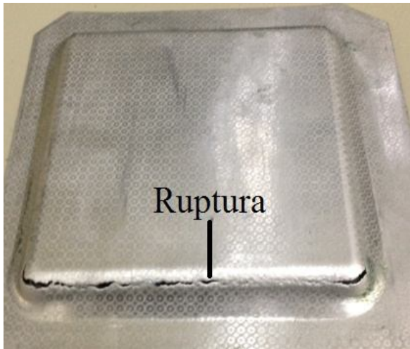
Figura 14: Ruptura do alumínio Fonte: Os autores
