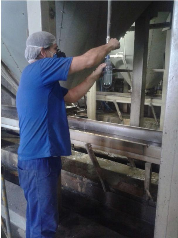
Figura 1: Coleta da amostra de água na entrada da tubulação da caldeira.
