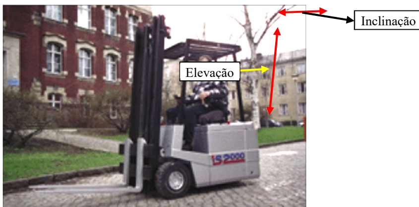
Figura 1: Empilhadeira com movimentos hidráulicos a água Fonte: Krutz (2004).
